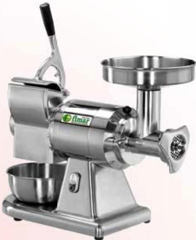
Struttura in alluminio lucidato con trameggia in acciaio inox - gruppo macinazione in acciaio inox completamente estraibile - bocca ingresso carne ø 52 mm - riduttore con ingranaggi a bagno d'olio - in dotazione sistema enterprise con piastra inox (fori ø 6 mm) e coltello inox autoaffilante. La parte della grattugia è caratterizzata da: bocca in alluminio lucidato - rullo in acciaio inox - griglia inferiore di protezione - microinterruttore leva pressore grattugia.
